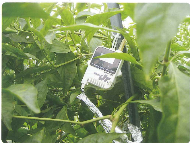
万願寺とうがらしハウスに温度センサーを設置し、24時間記録
