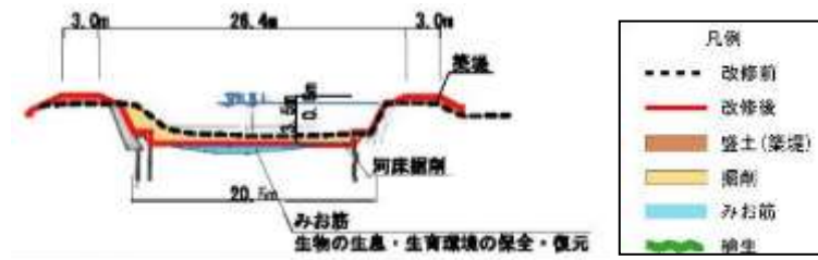
図- 3 大谷川改修計画断面図
