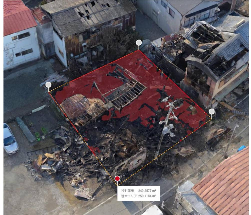
火災現場のデジタルツインにより、焼失面積の測定、火災原因調査に活用。
