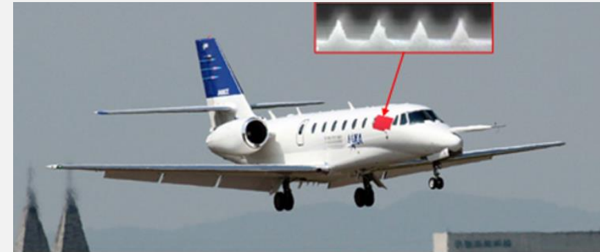
リブレットを機体表面に適用した航空機の飛行試験
