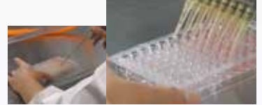
左) 通常は1ウェルずつの吸引 右) 本製品では8チャンネル同時に吸引可能
