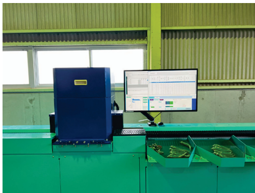
AI 精選別機(シブヤ精機製) 左側の青い箱が選別機本体 10 果実/秒を全周撮影で判別
