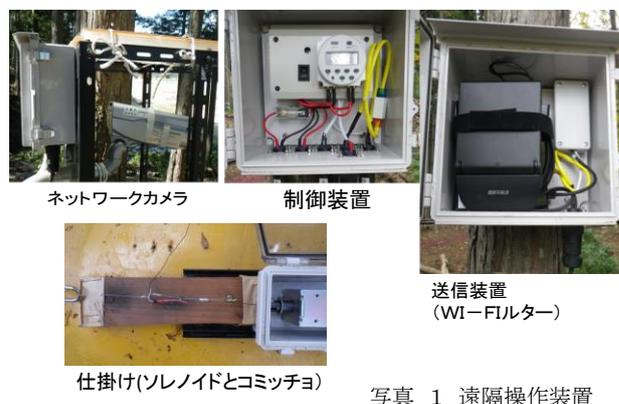
写真1 遠隔操作装置
