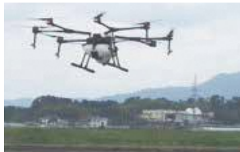
農薬散布用ドローン (作業時間約70%削減)
