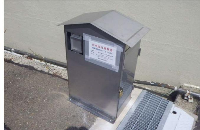
飛来塩分捕集器（土研式塩分捕集器）
