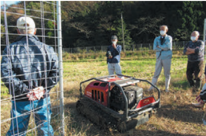
ラジコン草刈り機の実証実験
