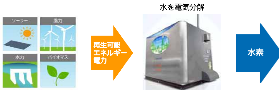
図3 再生可能エネルギー由来水素ステーション
