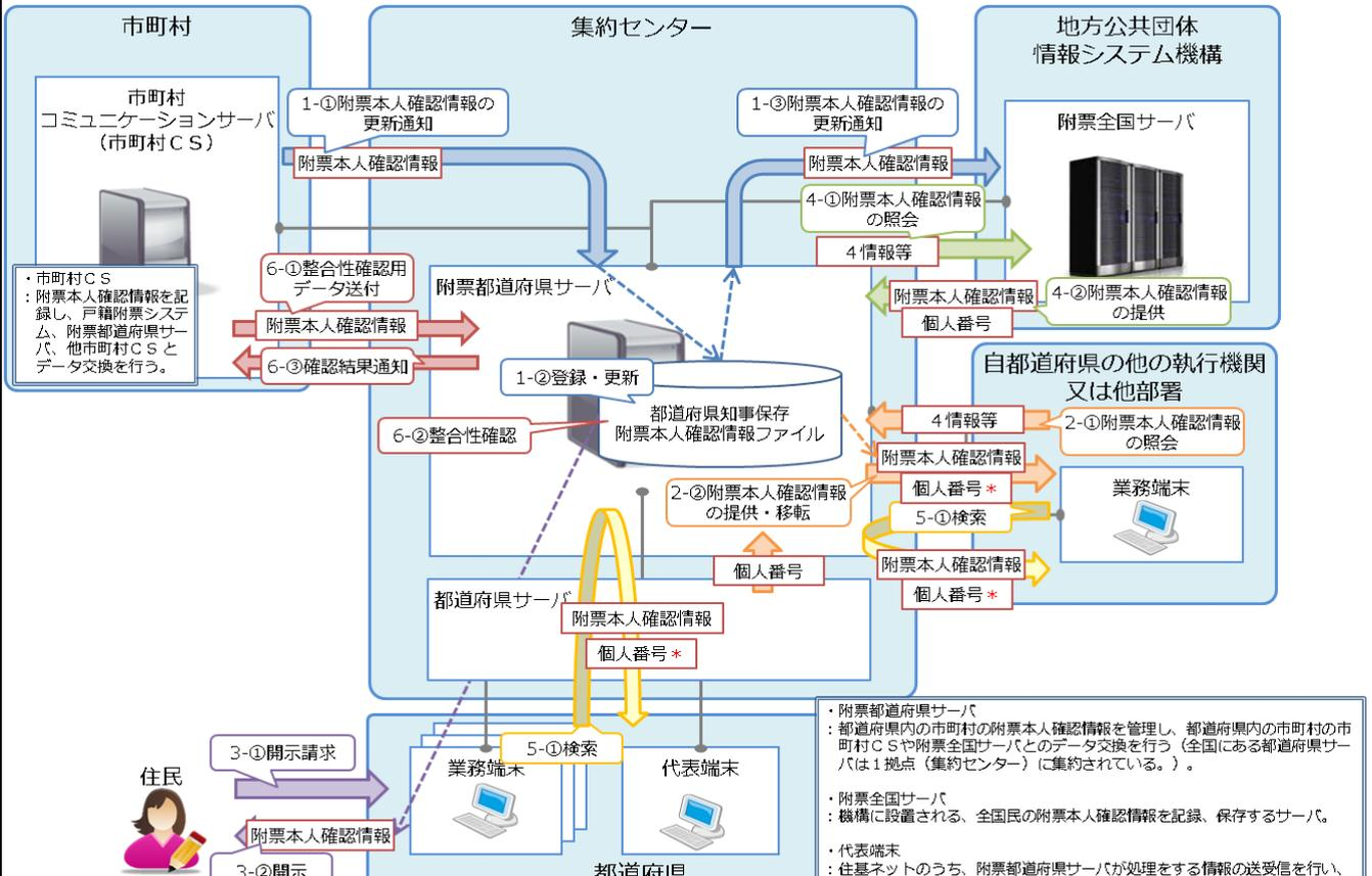
附票都道府県サーバと業務端末とを中継するため、本庁に設置する電子計算機。
